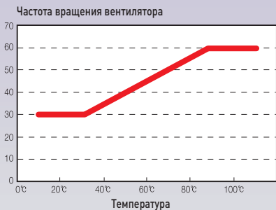
Контроль частоты вращения вентилятора в зависимости от температуры
